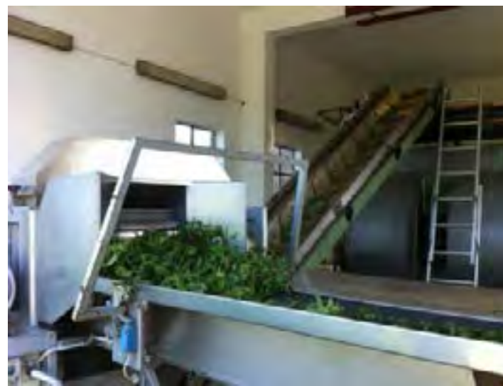
Linija za odvajanje lista od stabljike, Foto: Marko Kovač
