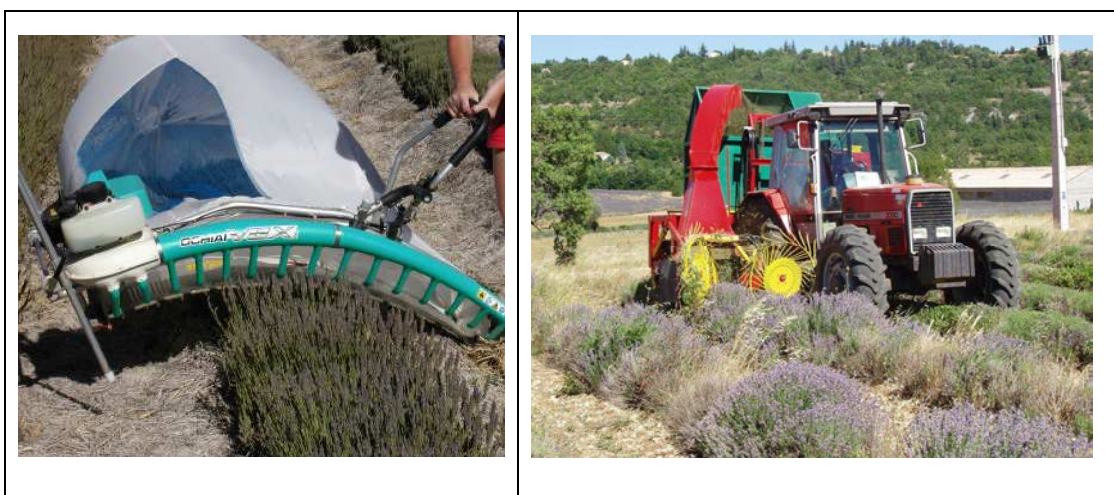
Slika 10. Ručno nošena motorna kosilica za žetvu ljekovitog i aromatičnog bilja (lijevo, izvor: http://www.pico-gro.co.za/ ) i kombajn za žetvu lavande (desno, u Provansi)
